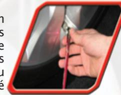
**Étape 3** Complétez la vérification de la pression d'air. Retirez le bouchon de valve de l'un de vos pneus, enfoncez fermement le vérificateur sur la valve et mesurez la pression.
