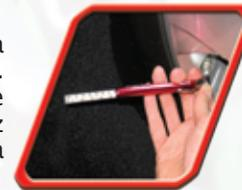
**Gonflez votre pneu** pour amener la pression d'air au niveau recommandé. Si vous gonflez trop le pneu, laissez échapper de l'air en appuyant sur la tige métallique au centre de la valve. Ensuite, mesurez de nouveau la pression d'air avec votre vérificateur.
