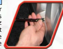
**Réinstallez** le bouchon de valve. Mesurez de la même façon la pression de vos autres pneus, sans oublier votre pneu de secours..
